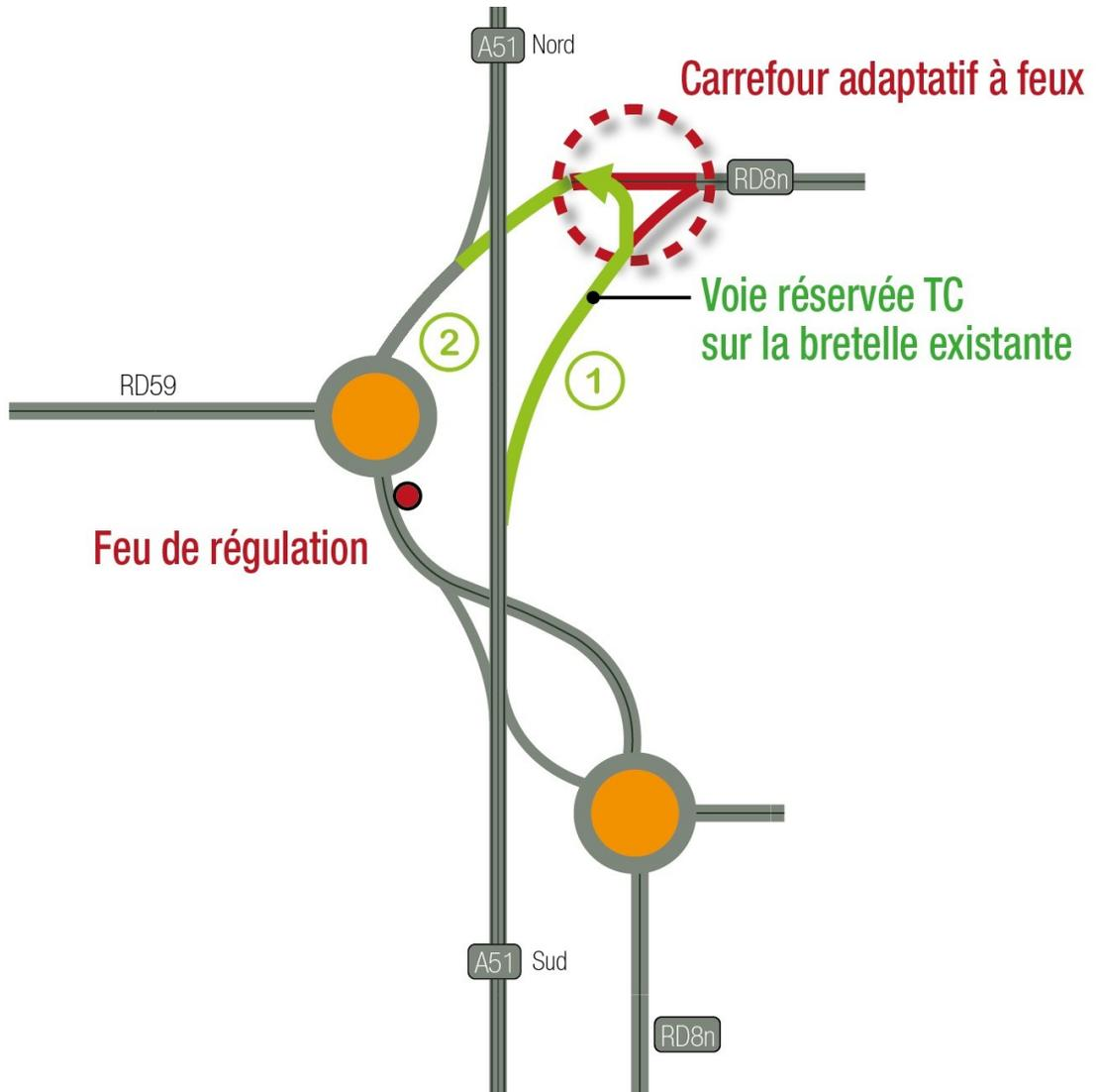
Schéma : Travaux d'aménagement de l'échangeur A51/RD8n (PHASE 1)
